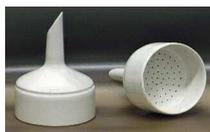
Utilizado na filtração à vácuo
