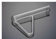
Auxilia na determinação do ponto de fusão e ebulição
